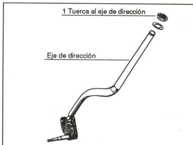
Figura 25.- Fijación del eje de dirección
